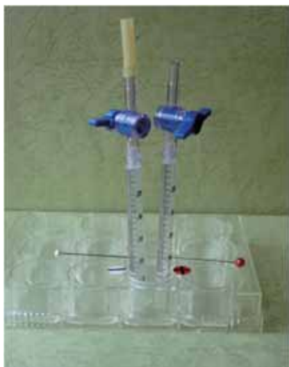
図1 1ミリリットル注射筒2本, マイクロプレートでつくった電解装置
